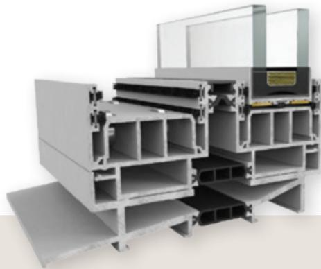
Die **Miniline** ist eine minimalistische Glasschiebewand. Alle Aluminiumprofile sind in den Boden, die Decke und die Wände eingebaut. Sichtbar ist nur das vertikale Aluminiumprofil von nur 20 mm Breite.
