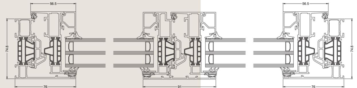
Star75 mit verdecktem Flügel ist sehr elegant und unauffällig. Das Konzept der verdeckten Flügel passt sich dem Trend schlanker und minimalistischer Fenster an. Bei diesem einzigartigen Fenstersystem mit Innenschalung sind feststehende Flügel von außen nicht von zu öffnenden Fenstern zu unterscheiden.
