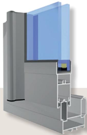
Profilsystem ohne thermische Trennung für leichte Schiebetüren und -fenster, mit einem maximalen Flügelgewicht von 150 kg. Realisierbar mit 2, 3, 4 oder 6 Flügeln.
