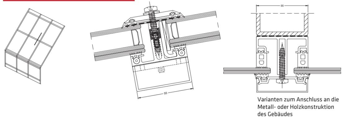
Varianten zum Anschluss an die Metall- oder Holzkonstruktion des Gebäudes
